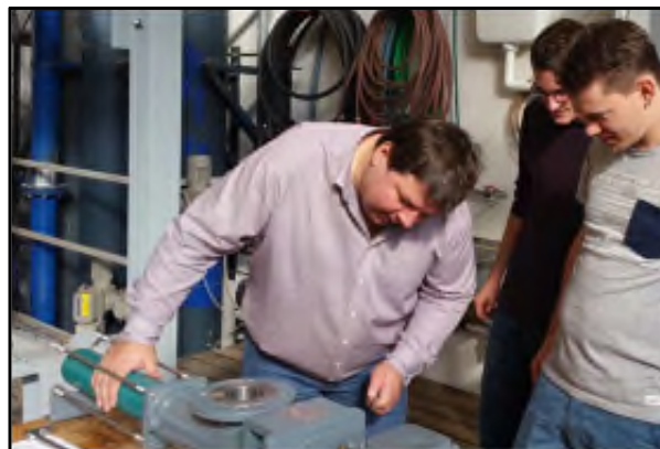
Demontage einer Exzentrerschneckenpumpe bei einer Präsenzveranstaltung an der TU Graz
